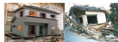
多度津工学実験所での実大振動実験 実験と同じ震度7による被害
